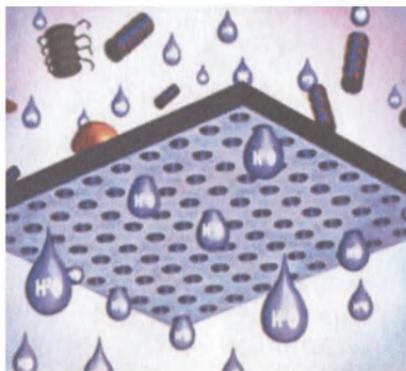
Под конец вспомним о том, что было сказано в самом начале. Смешивание пресной и соленой воды способно дать энергию. Если достаточно большой резервуар разделить полупроницаемой мембраной и подвести к нему с одной стороны трубопровод с морской водой, а с другой — с пресной, в резервуаре возникнет течение, которое можно использовать для вращения турбины.
